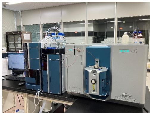
追加導入機：Sciex社製 Triple Quad 7500
